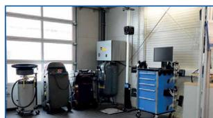
Neueste Reparatur- und Diagnosegeräte stehen in der Servicehalle bereit, wie etwa eine computergesteuerte Achsmessung oder Geräte zur Überprüfung von Klimaanlage.
