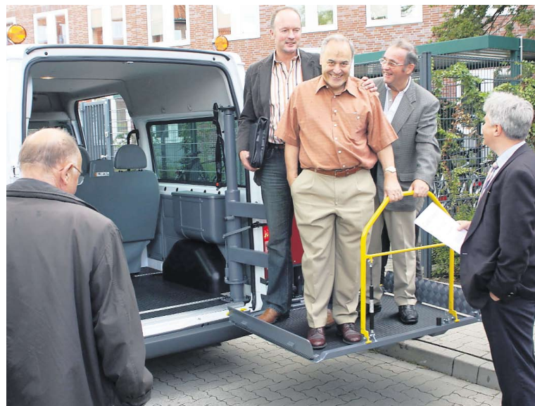
Als Anruf-Sammel-Taxis setzt die Firma Maass-Reisen als Betreiber vier nagelneue Fahrzeuge ein – neben drei Ford Transit (Foto links) ein VW Caravelle. Die Fahrzeuge sind unterschiedlich ausgestattet. Auf dem Foto rechts wird der hydraulische Hublift mit einer Tragfähigkeit bis 350 Kilogramm für elektrische Rollstühle getestet. Fotos: Wendt
